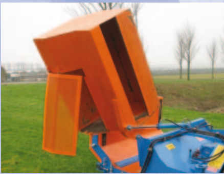
Vidange sur le coté de la trémie de récupération
