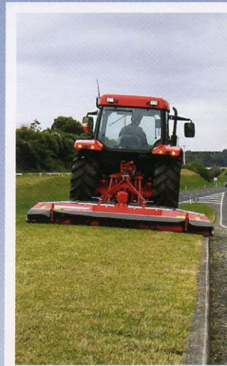
Tonte le long de bordures grâce aux rouleaux.
