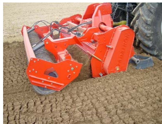
Système d'attelage rapide du châssis rouleau arrière, Contrôle hydraulique profondeur de travail et lame niveleuse
