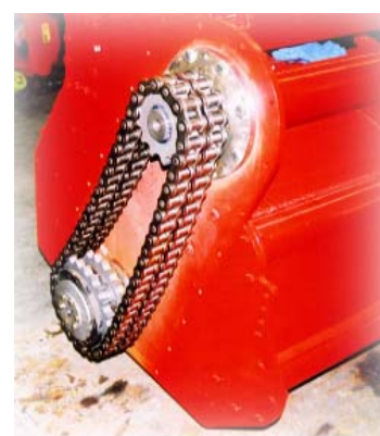
Double entraînement, deux chaînes par côté et sécurité par double limiteurs de couple (brevets DAIRON SAS)
