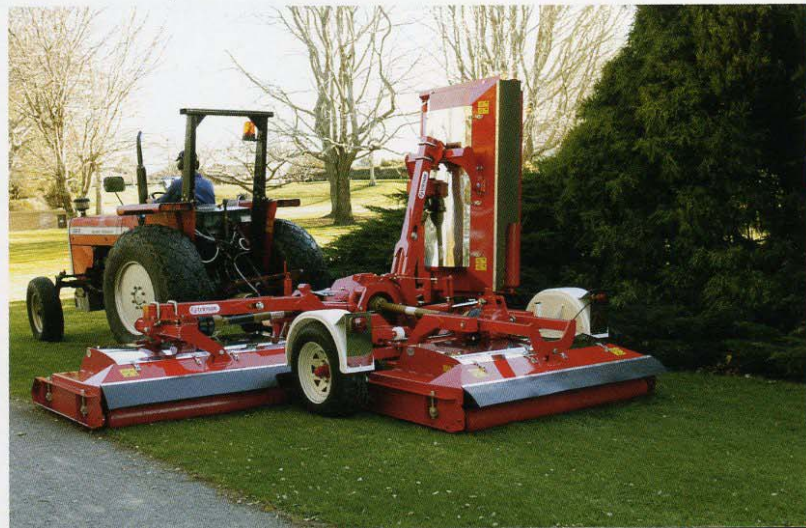
Le relevage individuel d'un plateau de coupe permet d'opérer dans des zones plus confinées avec aisance.
