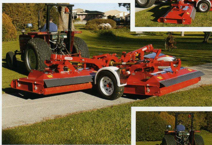
Système de contrôle hydraulique des plateaux et de passage de bordure.
