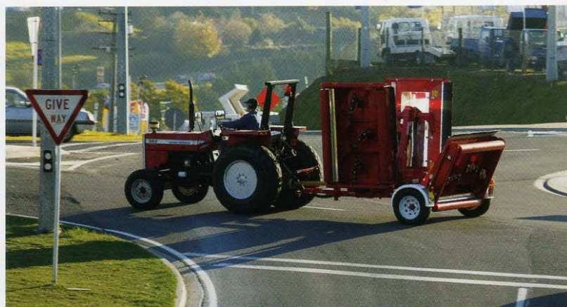
Passer d'un site de tonte à l'autre devient facile et en sécurité. Les plateaux sont relevés hydrauliquement et bloqués automatiquement en position haute – et au gabarit routier – pendant le transport de la Pegasus.
